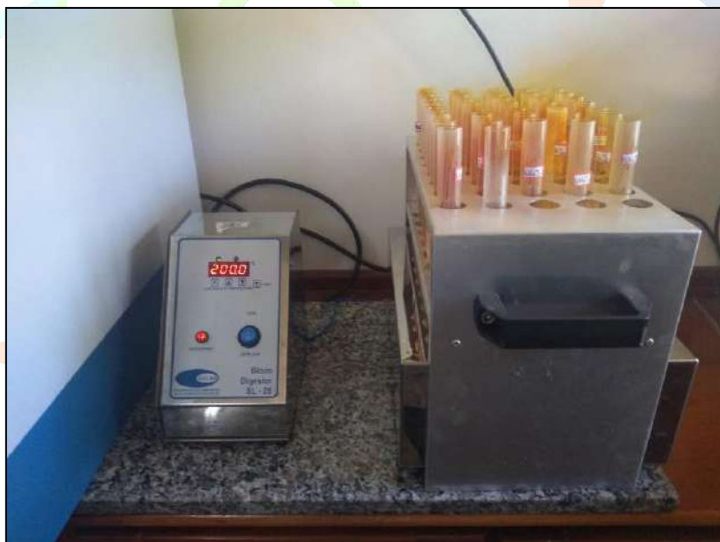
Figura 2 - Amostra em bloco digestor
